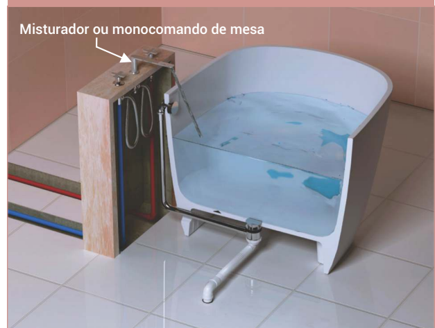
Opção 4: Monocomando de mesa instalado na mureta
