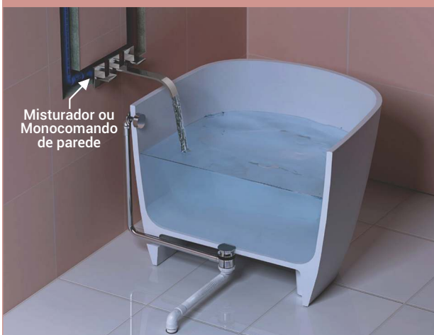
Opção 3: Misturador ou monocomando instalado na parede
